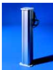
Hubsäule, elektrisch Höhenverstellung (von 670 bis 1140 mm), Spindelantrieb gegen ungewolltes Abfallen gesichert.
