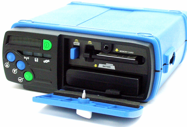
Figura 3.2 Instalando una Batería Interna
