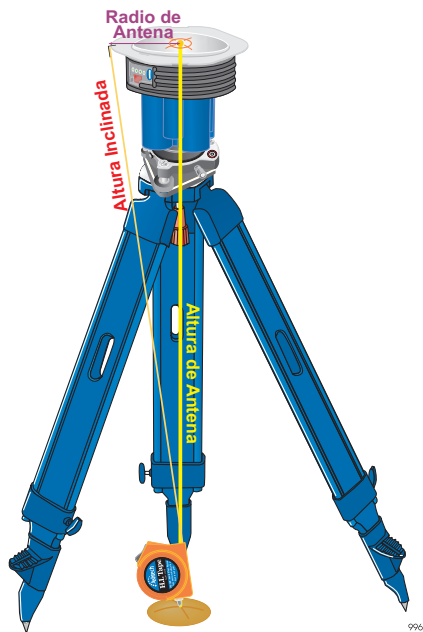
Figure 3.34: Medición de Altura de Antena
