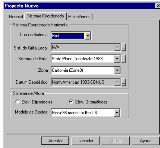
Figura 13.2. Nuevo Proyecto - Sistema Coordenado
