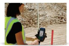
Le ProMark3 RTK peut être utilisé en mobile seul, connecté à un réseau temps réel. Une connexion Bluetooth entre le ProMark3 RTK et un téléphone portable suffit.
