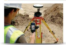
À l'instar du ProMark3 originel, le ProMark3 RTK inclut des fonctions de posttraitement. Les données brutes, enregistrées simultanément durant les jobs RTK, peuvent également être post-traitées grâce au logiciel de bureau GNSS Solutions pour assurer une intégrité maximale au levé. Le post-traitement permet d'avoir un contrôle total sur la qualité des données collectées.
