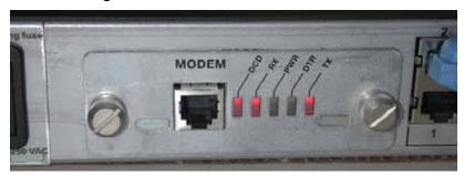
Figure 2-6. SCS1620 Modem Module
