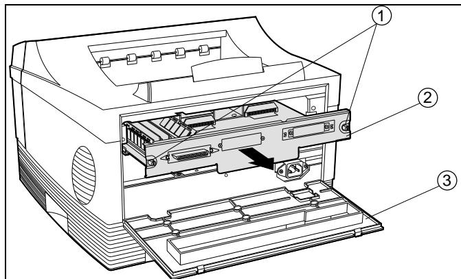
**LOOSEN THE SCREWS AND REMOVE THE SYSTEM CONTROLLER BOARD.**
