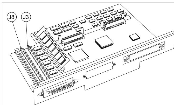
**LOCATE SLOT J3 OR J8 ON THE CONTROLLER BOARD.**
