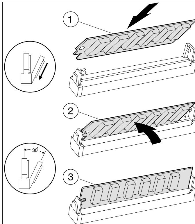
**INSTALL THE MEMORY MODULE INTO SLOT J3 OR
