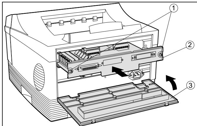
**REINSTALL AND SECURE THE CONTROLLER BOARD
