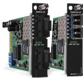
FRM220-1000E-2F FRM220-1000ES-2F Managed Giga Ethernet Converter
