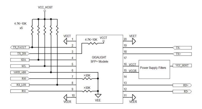
Figure 4. Host-Module Interface
