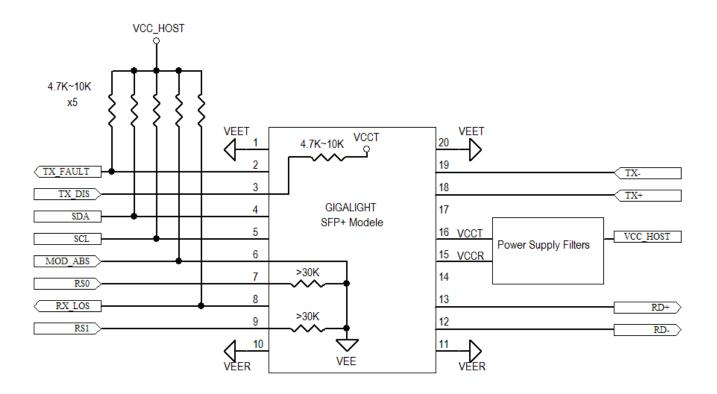
Figure4. Host-Module Interface
