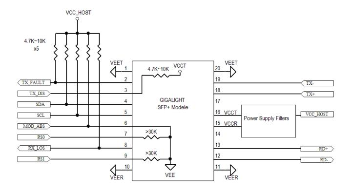
Figure 4. Host-Module Interface
