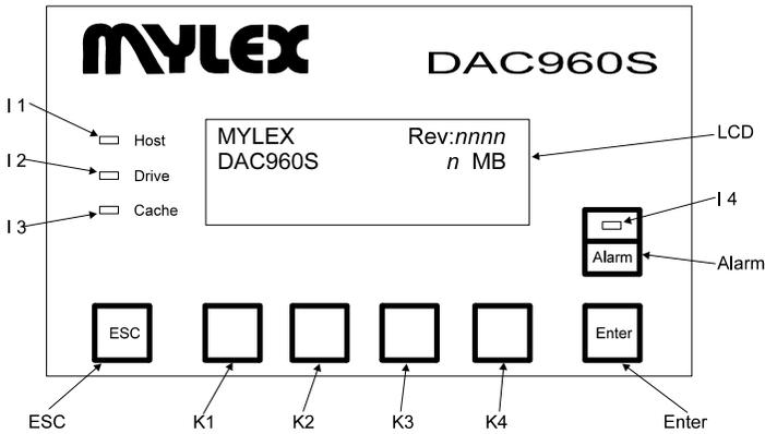
**Figure 1-3. DAC960SI Front Panel**
