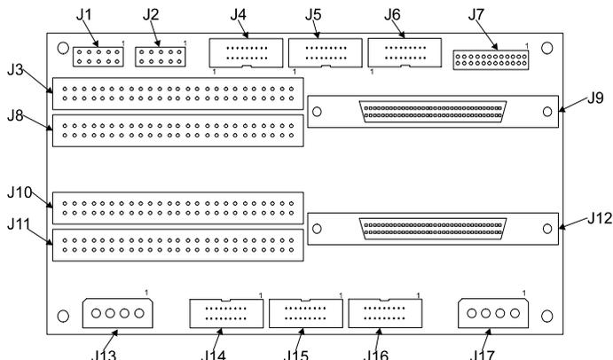
**Figure 1-6. DAC960SI-5-n Fast SCSI Distribution Board**
