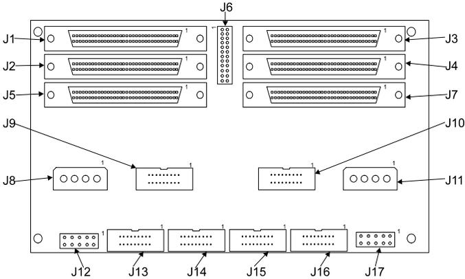
**Figure 1-7. DAC960SI-5W-*n* Wide SCSI Distribution Board**
