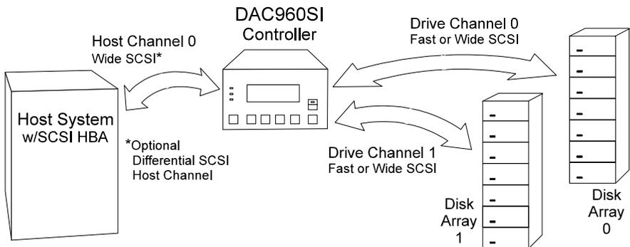
**Figure 2-1. System Block Diagram**
