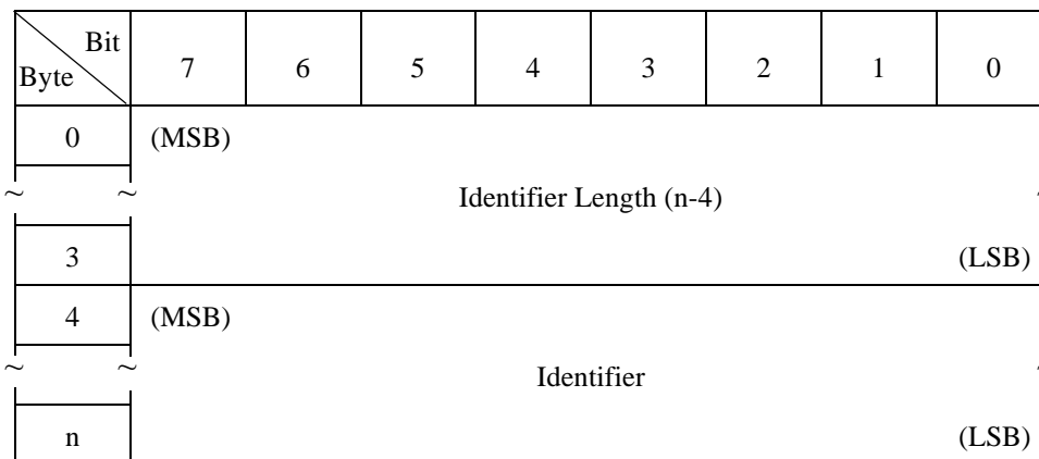
Figure 3.20 REPORT DEVICE IDENTIFIER: parameter list
