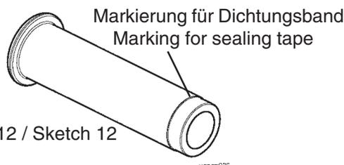
**5.4** Obere Dichtungskörperhälfte aufsetzen, andrücken und mit den beiliegenden Schrauben mit Unterlegscheiben durch abwechselndes Anziehen **langsam** schließen, bis die Verschußlehre paßt.
